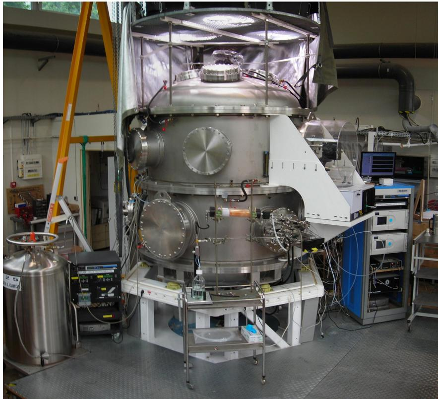
**Figure 19.** Vue de la chambre de simulation atmosphérique CESAM située au Laboratoire Interuniversitaire des Systèmes Atmosphériques à l'Université Paris Est Créteil. On distingue, en haut, 3 lampes xénon, à droite, un analyseur infrarouge fixé sur la paroi de la chambre et en bas, les différents analyseurs de la phase gazeuse.
